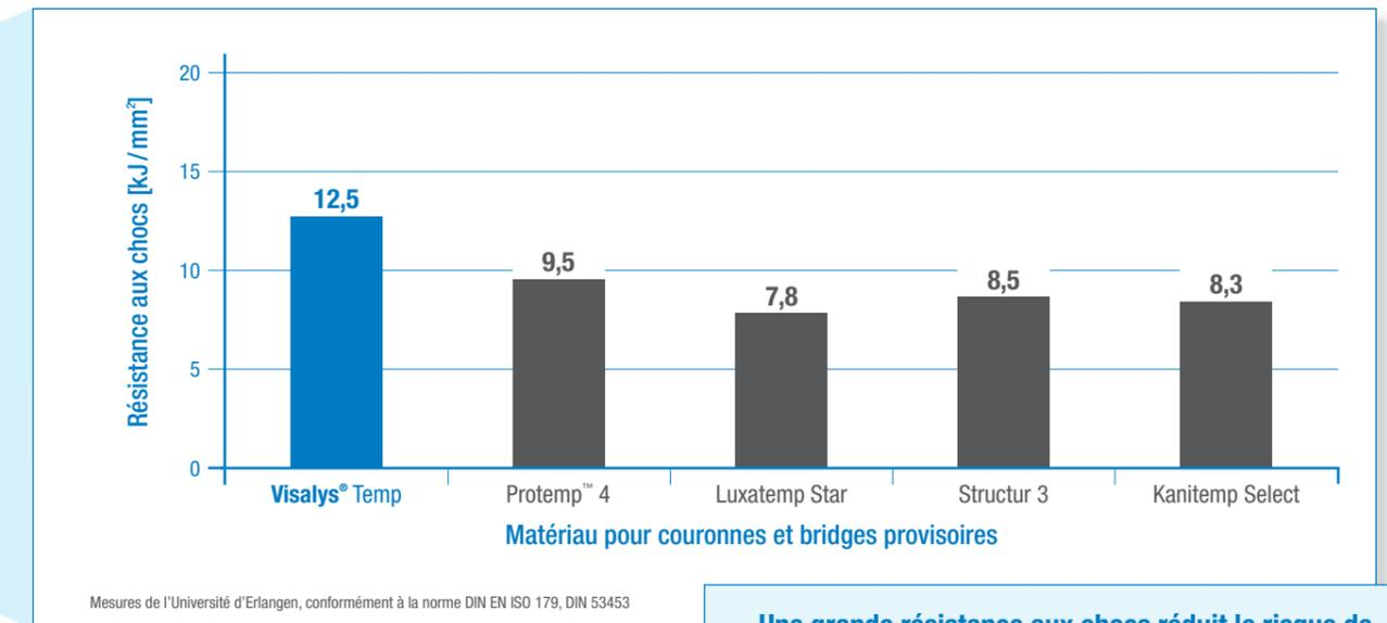
Une grande résistance aux chocs réduit le risque de bris d'une prothèse provisoire en bouche en cas de contraintes masticatoires élevées ou soudaines.
